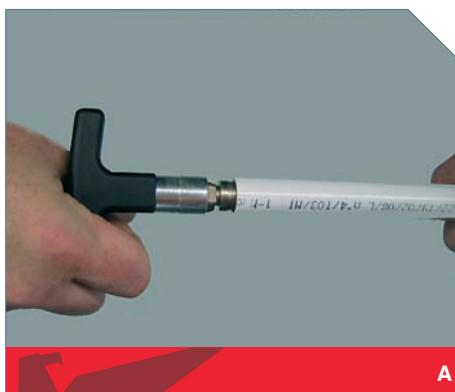
L’operazione consiste nel calibrare il tubo appena tagliato, impiegando l’utensile apposito, che va inserito nel tubo, ruotandolo in senso orario (foto A) fino a raggiungere la zona di svasatura (foto B).
